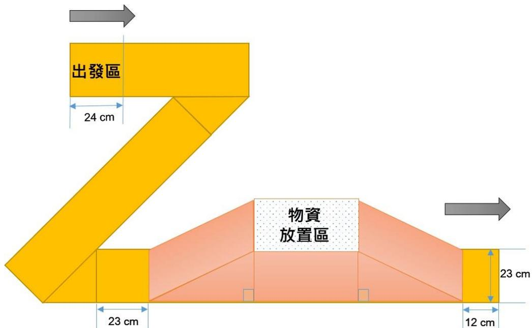
圖B：終點爬坡平臺規格尺寸示意圖
